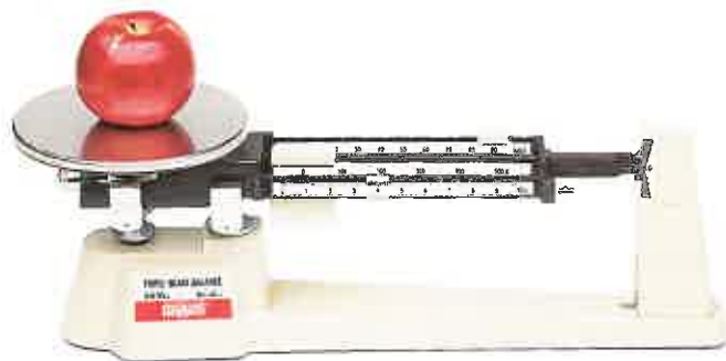
Figure 7.14 Une balance à trois fléaux indique que la pomme a une masse de 94 g.
